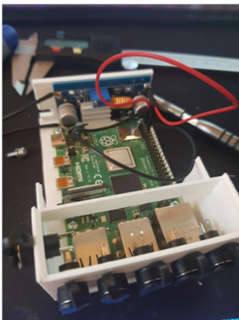
On passe maintenant à la soudure des connectiques. Pour ça, j'utilise du câble 20AWG en stock, mono-brin capable de supporter 5 ampères pour la connectique 12V des accessoires.
